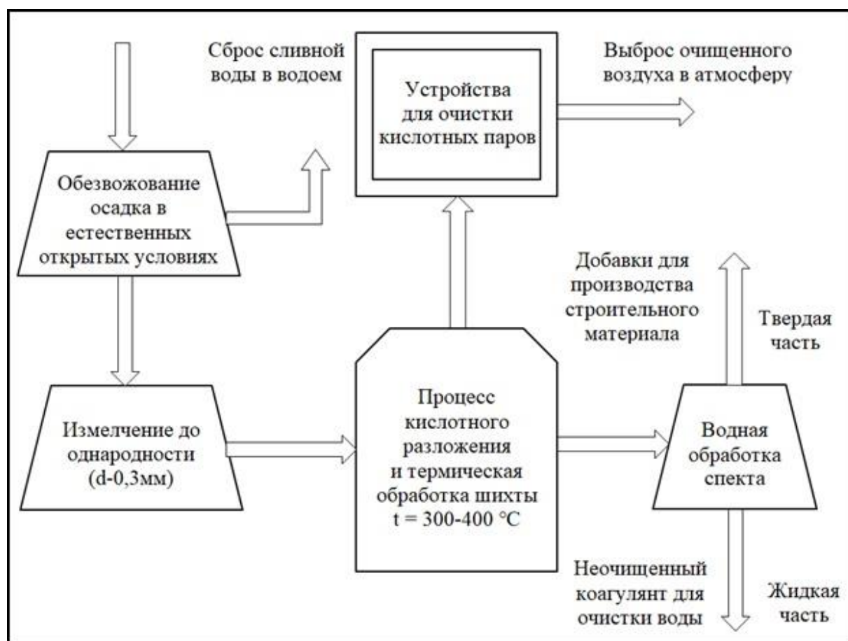
Рисунок 1. Рекомендуемая технологическая схема получения коагулянтов для очистки воды
